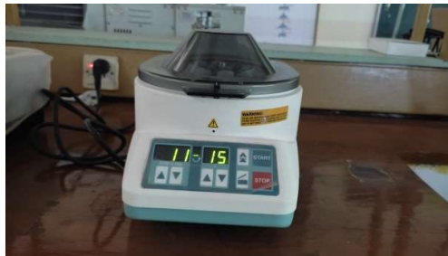
Proses sentrifugasi sampel yang akan diuji menggunakan metode MDA
