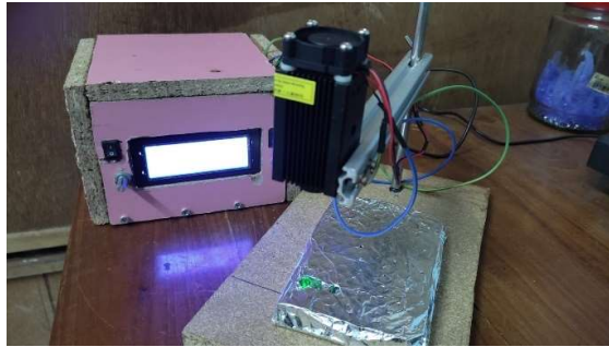
Proses penyinaran dengan menggunakan laser hijau 530 nm
