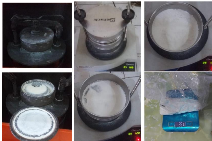
Gambar 3. Proses cangkang dipecah menjadi ukuran yang lebih kecil dan di-furnace selama 2 jam, disaring dengan ukuran -50+60 mesh.
