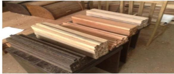
Gambar 2.5 Sampel Benda Uji dengan ukuran 15mm x 15mm x 500 mm
