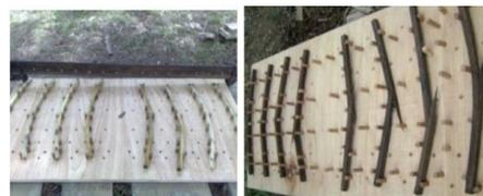
Gambar 2.7 Hasil sampel uji yang di uapkan pada bentuk yang di patok
