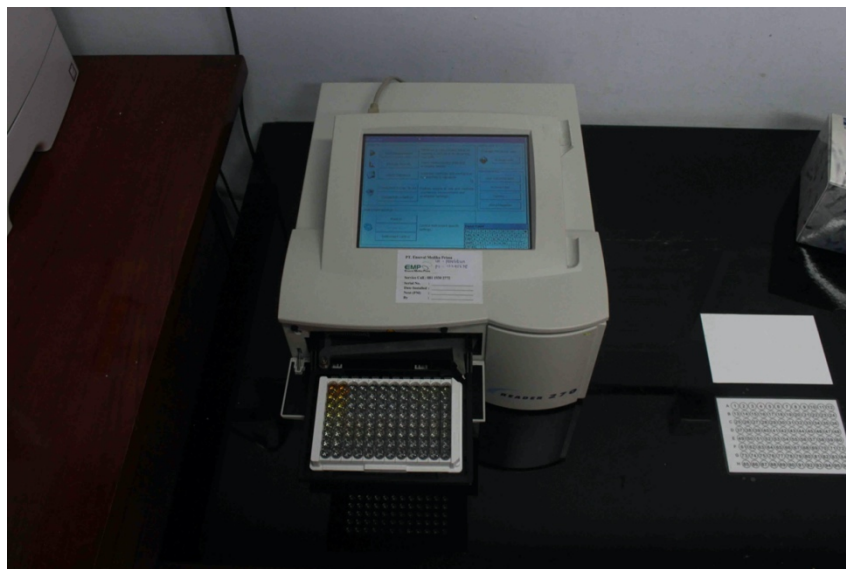
Baca plate kedalam mesin elisa dengan filter 450 nm
