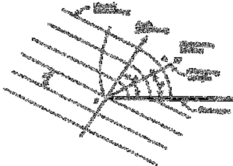
Gambar 2. 4 Difraksi gelombang di belakang rintangan (Triatmodjo, 1999)
