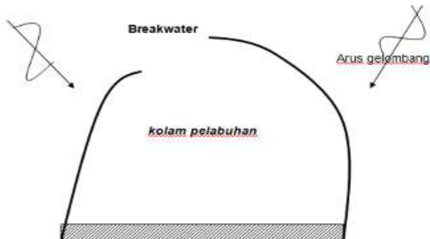
Gambar 2. 6 Ilustrasi pelindung breakwater pada areal pelabuhan (Triatmodjo, 2003)
