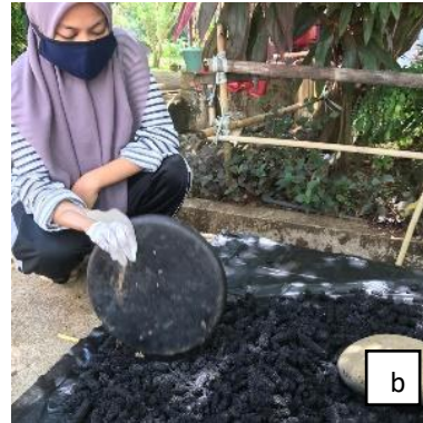
Lampiran Gambar 4. Proses pembuatan biochar tongkol jagung a. proses pembakaran tongkol jagung, b. proses penghancuran biochar tongkol jagung.
