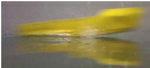
Kondisi Trim 3,955 derajat model kapal deadrise 5 derajat dengan 1 Stepped W dengan kecepatan 3,311 m/s
