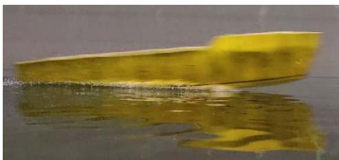
Kondisi Trim 4,839 derajat model kapal deadrise 5 derajat dengan 2 Stepped W dengan kecepatan 4 m/s
