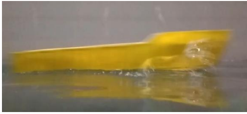
Kondisi Trim 2,579 derajat model kapal deadrise 5 derajat dengan 1 Stepped W dengan kecepatan 1,838 m/s
