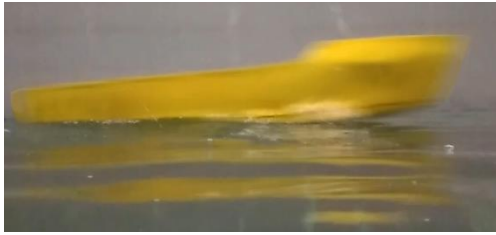
Kondisi Trim 3,434 derajat model kapal deadrise 5 derajat dengan 1 Stepped W dengan kecepatan 2,545 m/s
