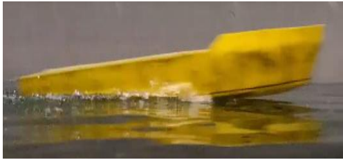
Kondisi Trim 4,699 derajat model kapal deadrise 5 derajat dengan 3 Stepped W dengan kecepatan 3,175 m/s
