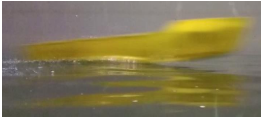
Kondisi Trim 3,906 derajat model kapal deadrise 5 derajat dengan 1 Stepped W dengan kecepatan 3,175 m/s
