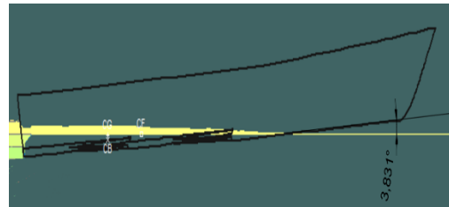
Kondisi Trim 3,831 derajat model kapal deadrise 5 derajat dengan 2 Stepped W dengan kecepatan 2,793 m/s
