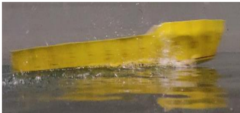
Kondisi Trim 3,831 derajat model kapal deadrise 5 derajat dengan 2 Stepped W dengan kecepatan 2,793 m/s
