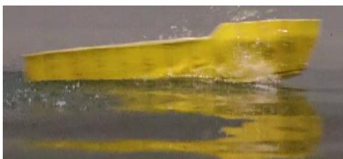
Kondisi Trim 3,975 derajat model kapal deadrise 5 derajat dengan 2 Stepped W dengan kecepatan 2,950 m/s
