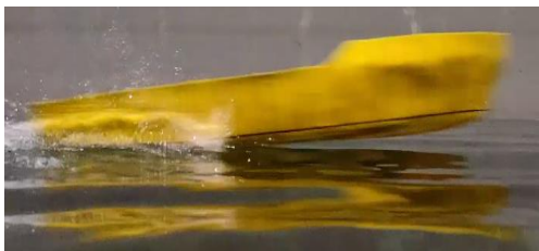
Kondisi Trim 4,974 derajat model kapal deadrise 5 derajat dengan 3 Stepped W dengan kecepatan 4,115 m/s
