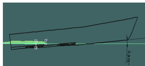
Kondisi Trim 3,975 derajat model kapal deadrise 5 derajat dengan 2 Stepped W dengan kecepatan 2,950 m/s
