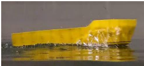
Kondisi Trim 3,256 derajat model kapal deadrise 5 derajat dengan 3 Stepped W dengan kecepatan 1,859 m/s
