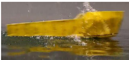
Kondisi Trim 3,655 derajat model kapal deadrise 5 derajat dengan 3 Stepped W dengan kecepatan 2,740 m/s
