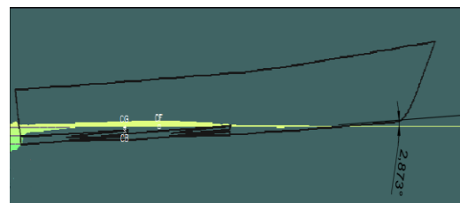
Kondisi Trim 2,873 derajat model kapal deadrise 5 derajat dengan 2 Stepped W dengan kecepatan 1,795 m/s
