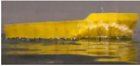
Kondisi Trim 2,819 derajat model kapal deadrise 5 derajat dengan 3 Stepped W dengan kecepatan 1,835 m/s
