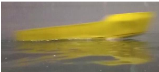
Kondisi Trim 3,558 derajat model kapal deadrise 5 derajat dengan 1 Stepped W dengan kecepatan 2,985 m/s
