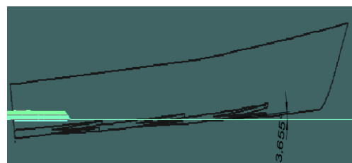
Kondisi Trim 3,655 derajat model kapal deadrise 5 derajat dengan 3 Stepped W dengan kecepatan 2,740 m/s
