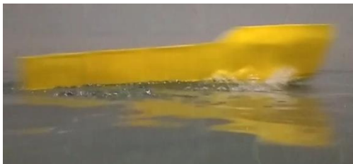
Kondisi Trim 2,590 derajat model kapal deadrise 5 derajat dengan 1 Stepped W dengan kecepatan 1,866 m/s
