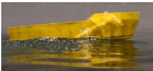
Kondisi Trim 3,402 derajat model kapal deadrise 5 derajat dengan 3 Stepped W dengan kecepatan 2,146 m/s
