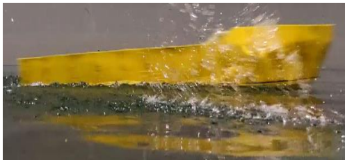
Kondisi Trim 3,580 derajat model kapal deadrise 5 derajat dengan 3 Stepped W dengan kecepatan 2,558 m/s
