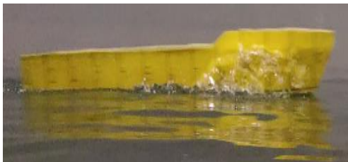
Kondisi Trim 2,873 derajat model kapal deadrise 5 derajat dengan 2 Stepped W dengan kecepatan 1,795 m/s
