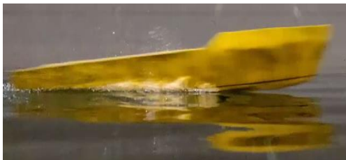
Kondisi Trim 4,802 derajat model kapal deadrise 5 derajat dengan 3 Stepped W dengan kecepatan 3,367 m/s
