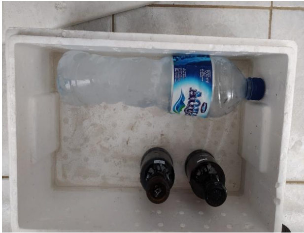
Inkubasi sampel di dalam winkler gelap selama 5 hari
