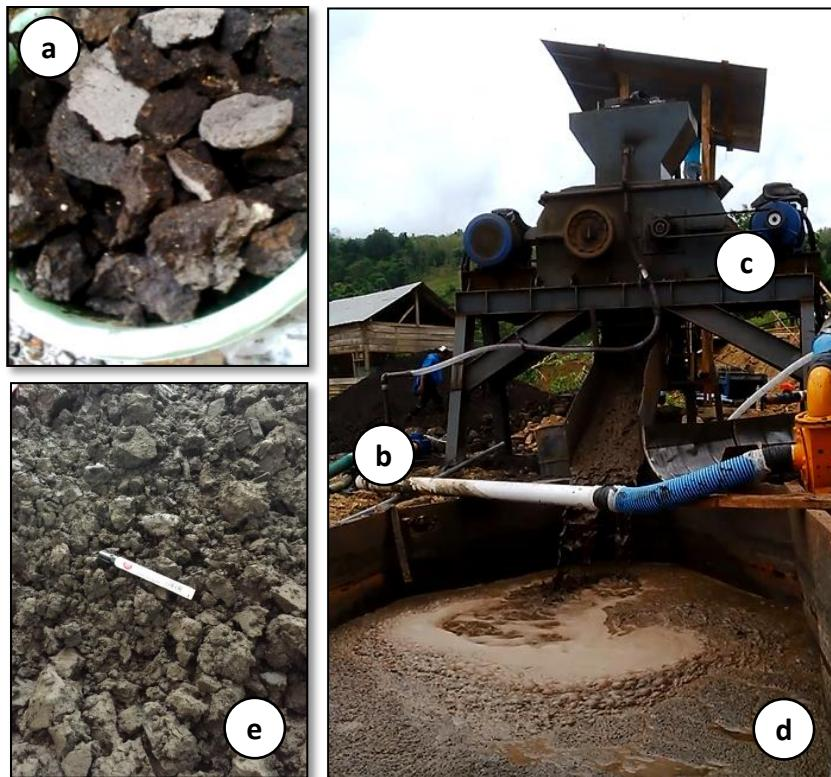
**Gambar 7.** Proses ekstraksi aspal buton. (a) Buton Granular Aspal (b) Aspal (c) mesin ekstraksi Aspal (d) lumpur limbah aspal buton (e) fraksi WBA.
