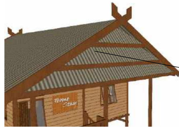
PENGGUNAAN ATAP TIMPA LAJA PADA BANGUNAN MENJADI CIRI KHAS PADA RUMAH ADAT SUKU BUGIS
