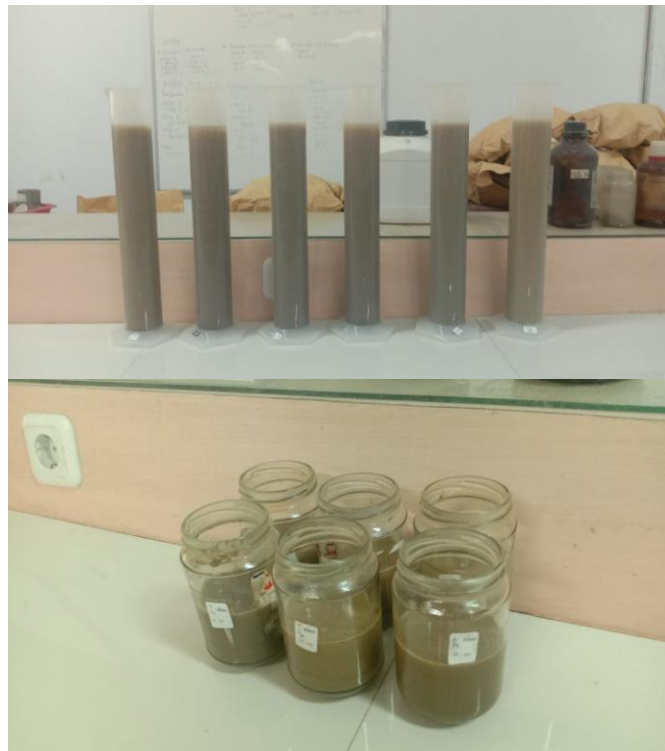
Proses pengukuran tekstur tanah menggunakan metode hidrometer
