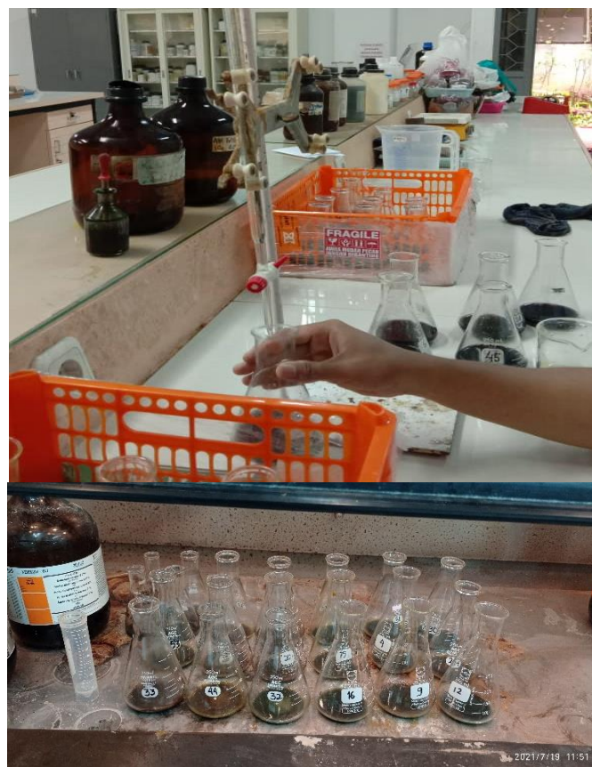
Proses pengukuran C-organik menggunakan metode walkley and black
