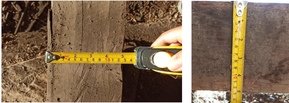
Gambar 3.1 Pengukuran Dimensi Lunas Kapal (Sumber: Dokumentasi Pribadi, 25 Februari 2021)
