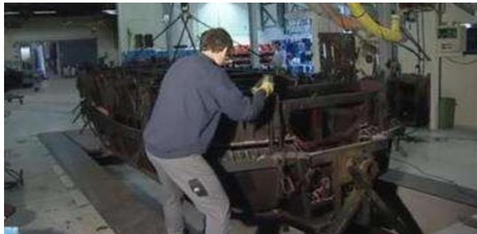
**Gambar 2.5** Proses penguncian cetakan
