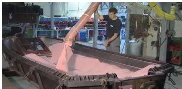
**Gambar 2.4** Proses pengisial pellets ke cetakan
