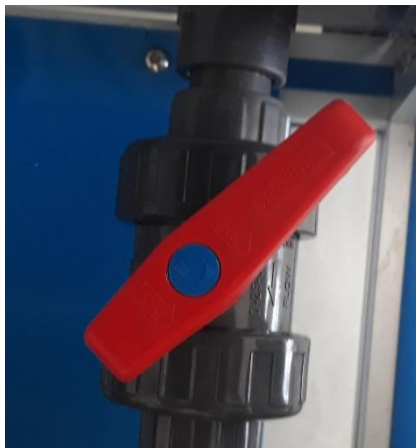
Gambar B2. Pembukaan katup saluran masuk 60% dan 40%
