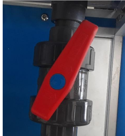
Gambar B1. Pembukaan katup saluran masuk 100% dan 80%
