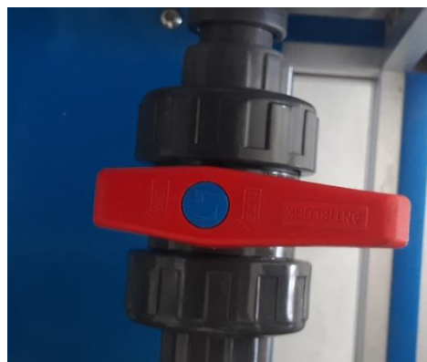
Gambar B3. Pembukaan katup saluran masuk 0%
