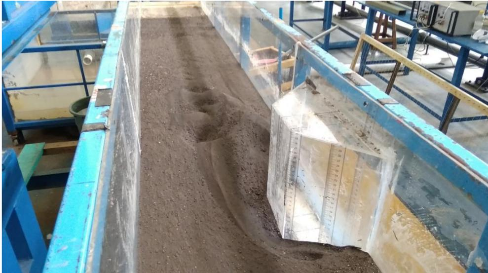
Gerusan pada saluran untuk variasi *running* 180 menit pada kemiringan saluran  $I_1 = 0,00375$
