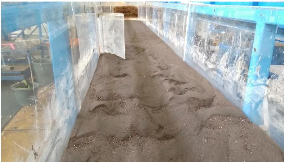
Gerusan pada saluran untuk variasi *running* 180 menit pada kemiringan saluran  $I_2 = 0,006$
