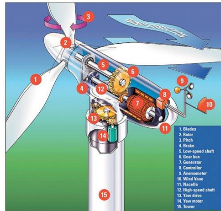
Gambar 2. 2 Komponen Turbin Angin
