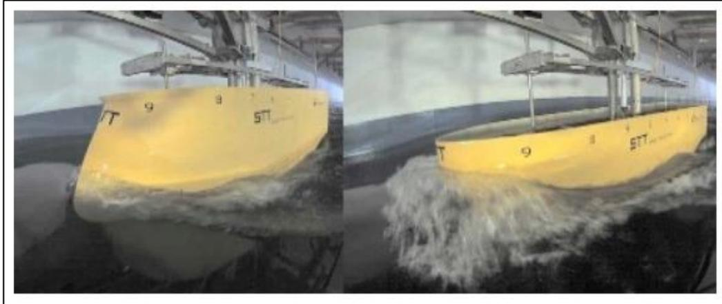
Gambar 2. 5 : Perbandingan gelombang menggunakan haluan *X-Bow* dan haluan biasa
