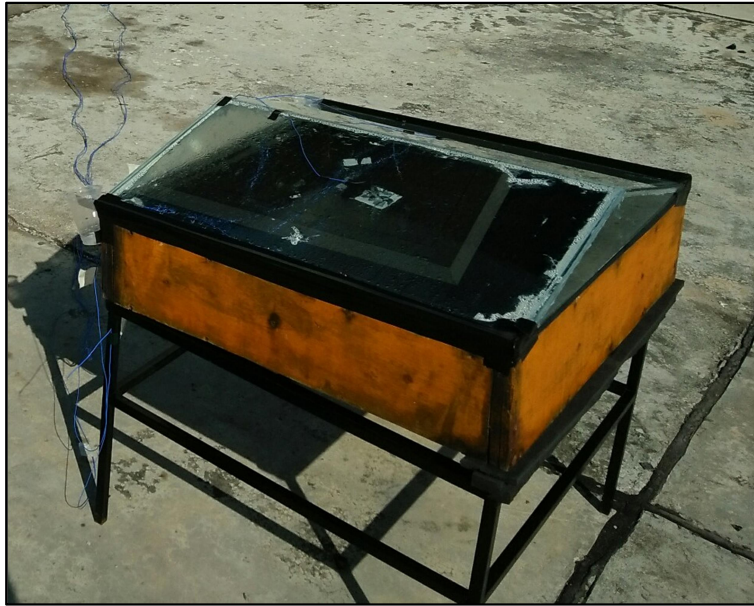
Gambar C.7 Proses pengujian alat distilasi pelat datar
