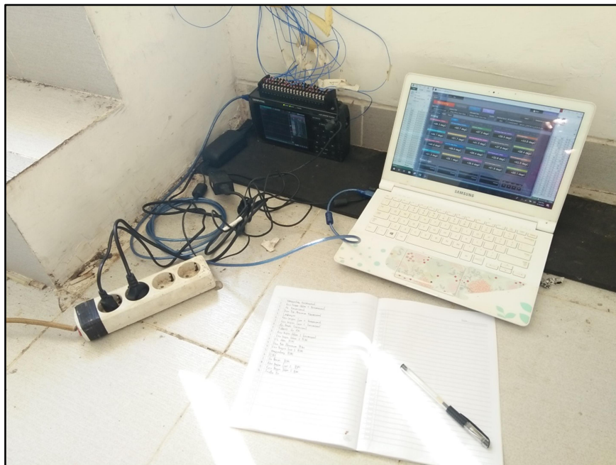
Gambar C.6 Midi Log dan Laptop untuk membaca nilai dari titik-titik ukur pada alat distilasi
