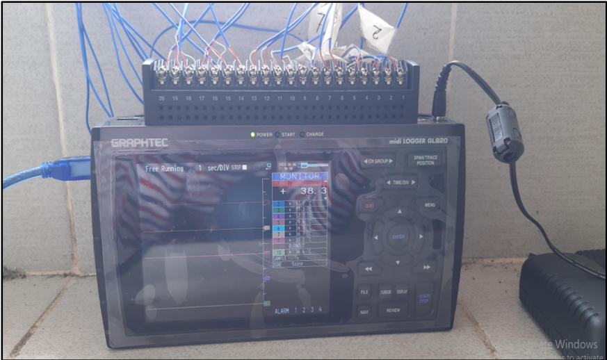
Gambar C.4 Tampilan Midi Log pada Saat Membaca Titik Titik Pengukuran Temperatur
