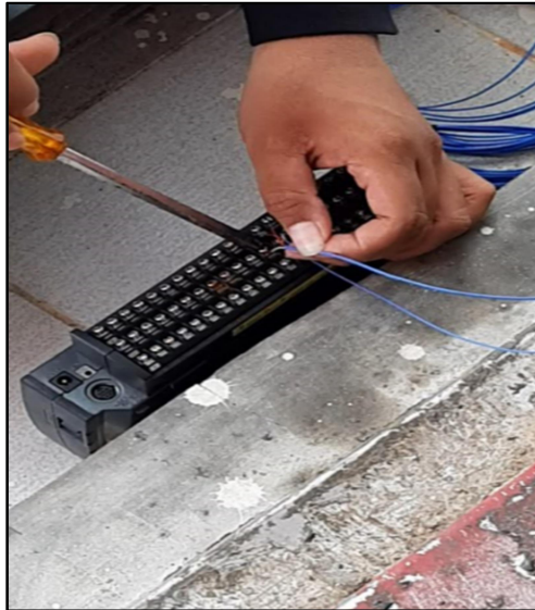
Gambar C.3 Penyambungan ujung termokopel untuk pemasangan pada kutub positif dan negative Midi Log
