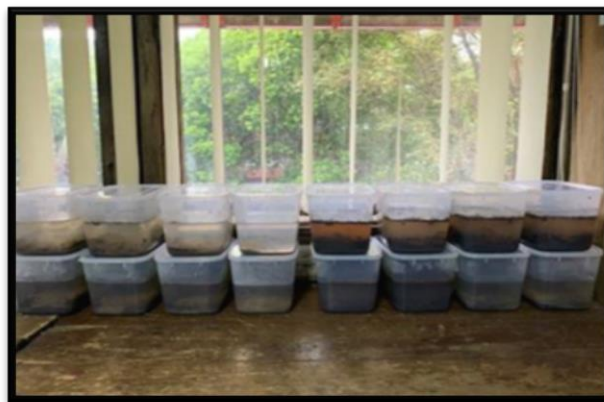
Desain Bioreaktor dengan Pemberian Sedimen Bakau dan Kompos sebagai Sumber Inokulum Bakteri Pereduksi Sulfat
