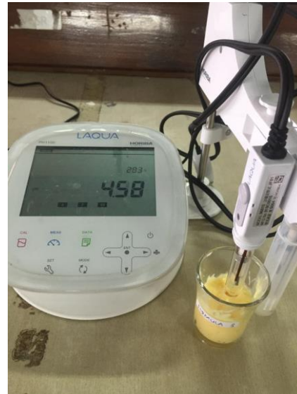
Gambar 26. Pengukuran pH sediaan krim
