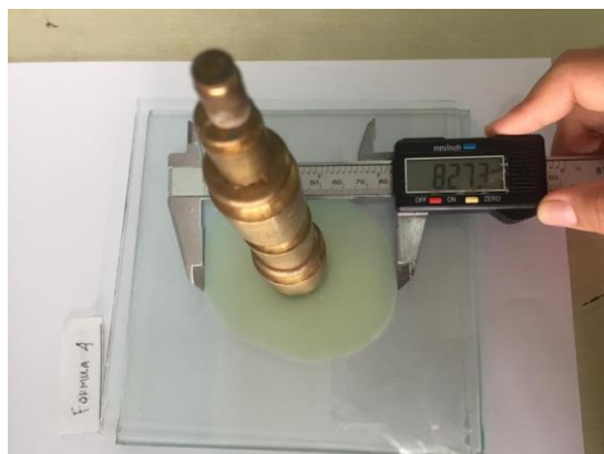
Gambar 28. Pengukuran daya sebar sediaan krim
