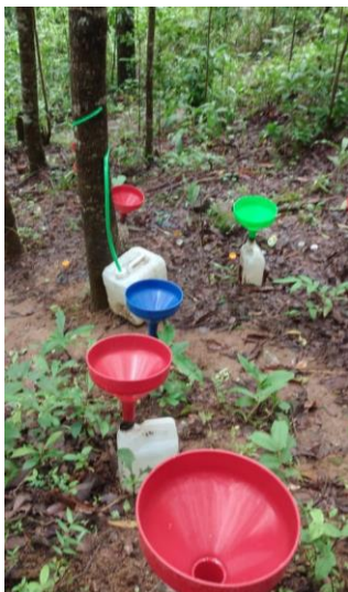
Peletakan jerigen untuk pengukuran air lolos
