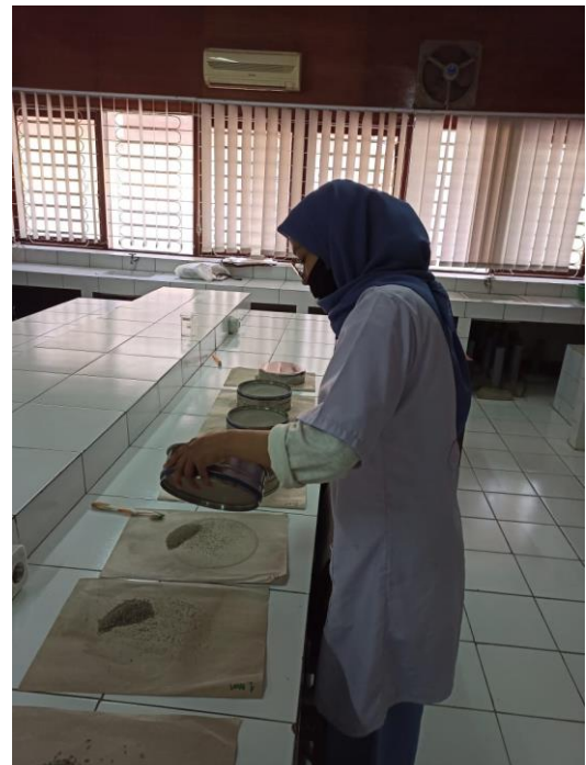
Gambar 2. a) pengeringan sampel sedimen, b) pengayakan sampel sedimen
