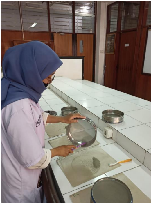
Gambar 2. a) pengeringan sampel sedimen, b) pengayakan sampel sedimen
