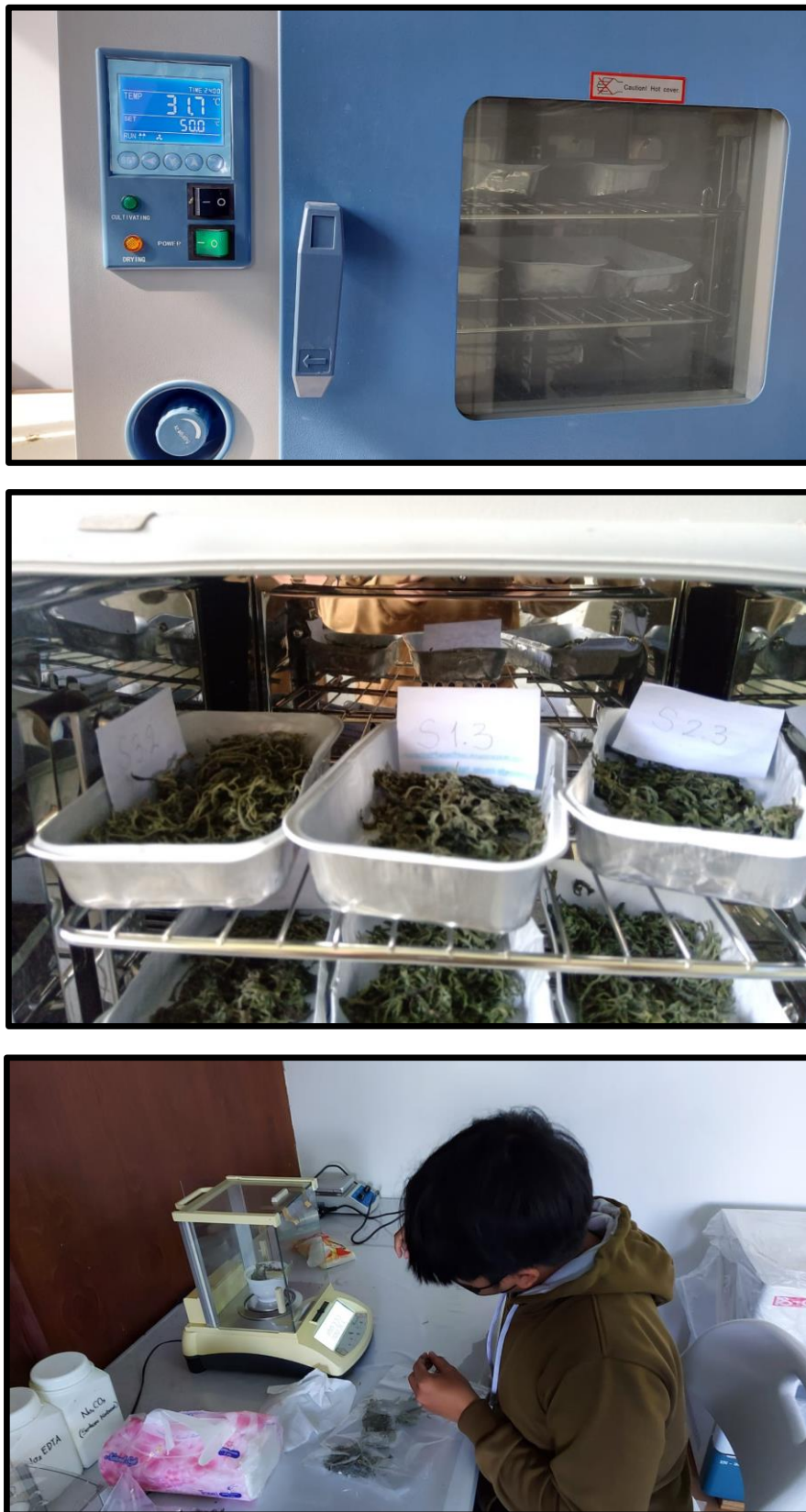
Gambar 9. Pengeringan sampel C. fragile untuk kemudian dianalisis dengan ICP-OES
