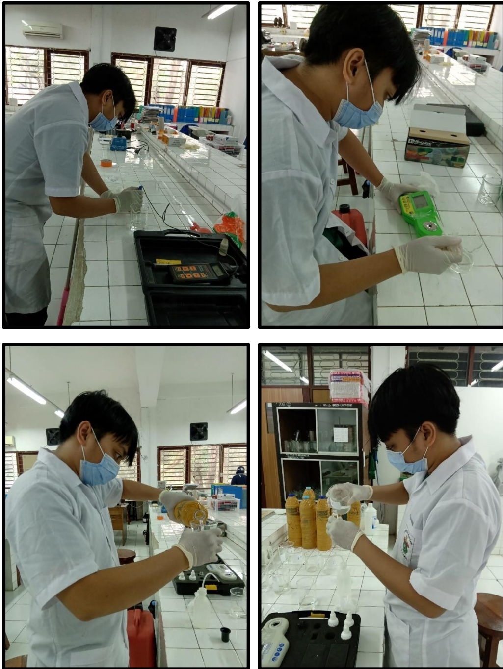
Gambar 10. Pengukuran parameter lingkungan (pH, salinitas, kekeruhan)
