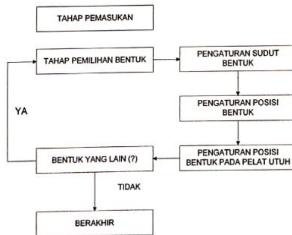
Gambar 2.22 Diagram kerja/ kesimpulan cara kerja dari pada pengaturan dasar sistem heuristic (rule-based heuristic nesting system) (Sumber: Younyoung, 2003)
