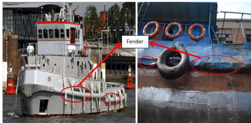
Gambar 1. 1 Struktur fender pada kapal laut (sumber : Z.Jiang M.Gu/Materials and Design 31,2010)
