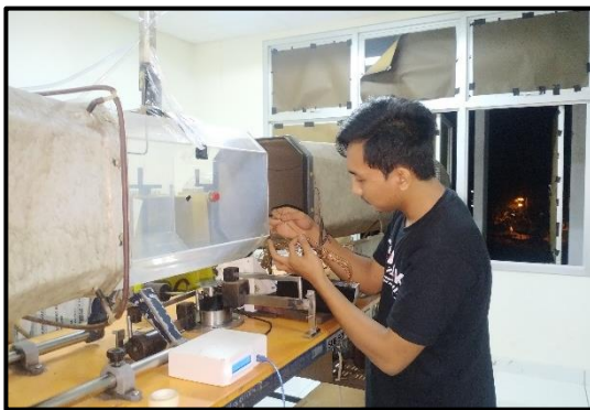
Proses pemasangan model uji pada wind tunnel
