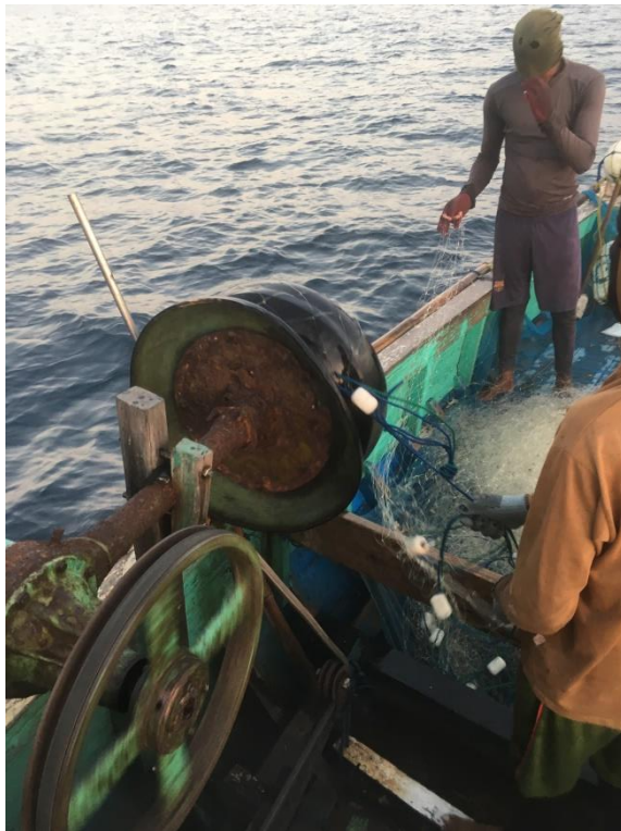
e. Proses penarikan jaring menggunakan alat bantu katrol
