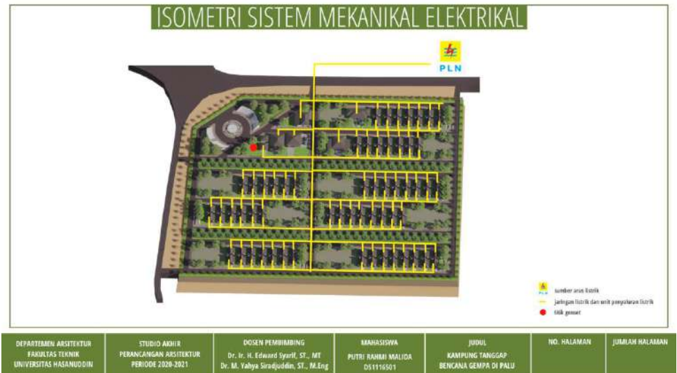
Gambar 11 Perletakaan Jalur Jaringan Listrik dan Komunikasi
