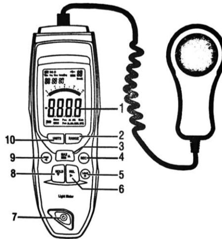
Gambar 2.7 Bagian – bagian *lux meter datalogger*
