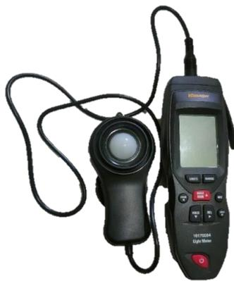
Gambar 2.6 *Lux meter datalogger*
