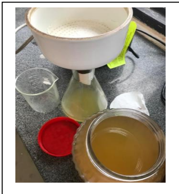
Gambar 20. Penyaringan Ekstrak Menggunakan Vakum
