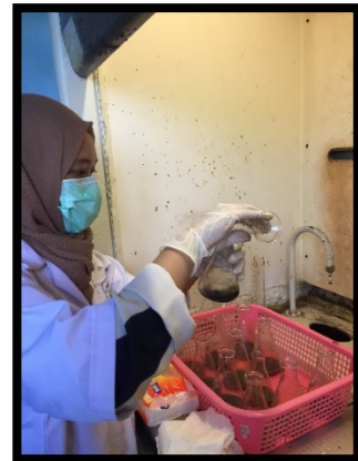
q. Destruksi sampel menggunakan \text{HNO}_3 untuk analisis logam berat
