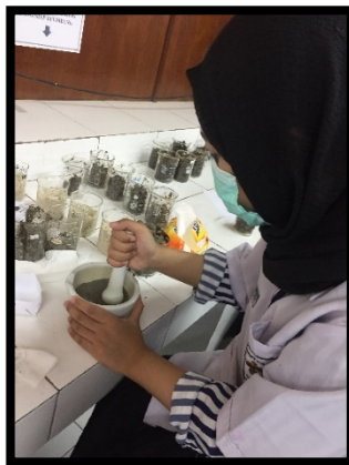
d. Sampel sedimen digerus menggunakan lumpang
