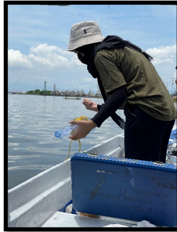
b. Pengambilan data kecepatan arus menggunakan alat layang-layang arus
