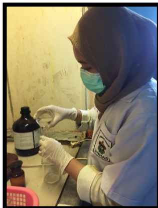
p. Penambahan larutan \text{HNO}_3 pada sampel sedimen untuk analisis logam berat
