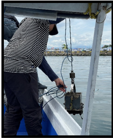
d. Pengambilan sampel sedimen menggunakan Eijkman Grab
