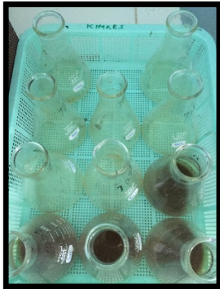
r. Sampel sedimen yang telah ditambahkan larutan asam nitrat dan asam perklorat
