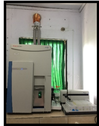
t. Alat ICP-OES untuk analisis kandungan logam berat pada sedimen
