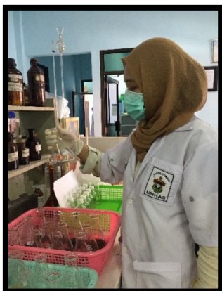
o. Penambahan aquades pada sampel sedimen untuk analisis logam berat
