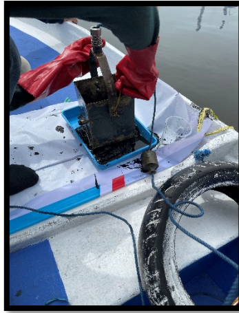
e. Pengambilan sampel sedimen menggunakan Eijkman Grab
