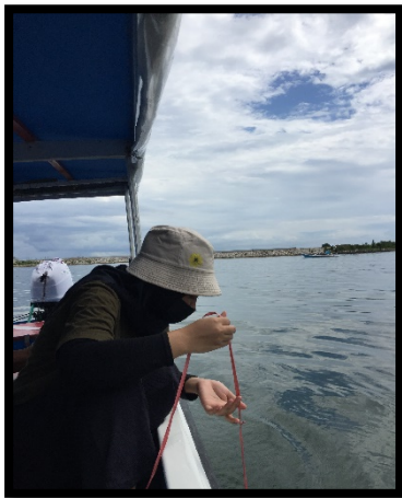
a. Pengambilan data kedalaman perairan menggunakan tali ukur
