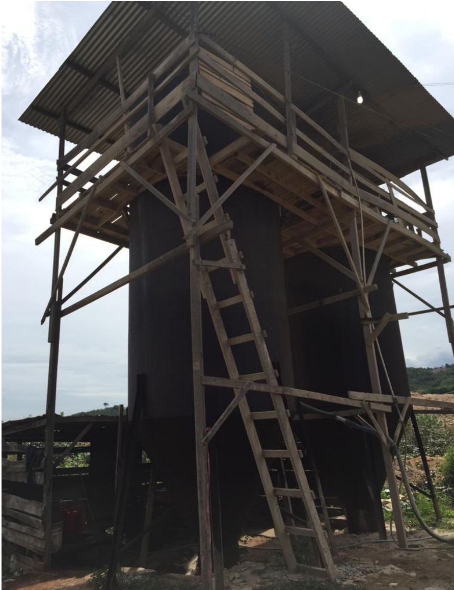
Gambar 17. Mesin Pertambangan Tong (Cyanidasi)
