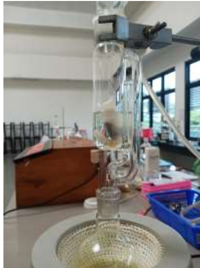
Gambar 11. Penetapan kadar lemak ekstrak Umbi Bawang Dayak ( Eleutherine americana (Aubl) Merr.) dengan metode sokhletasi
