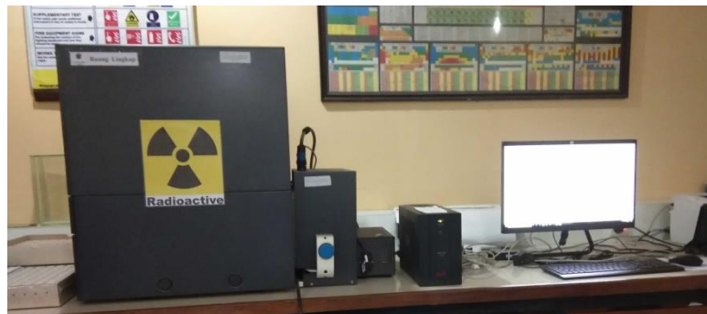
Gambar 9. Pengukuran aktivitas karbon menggunakan LSC Hidex 300 SL
