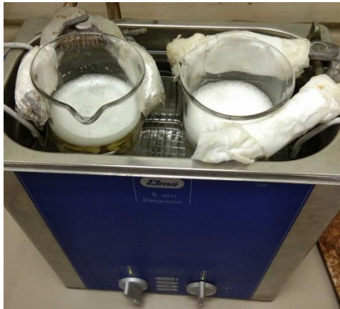
Gambar 7. Proses pencucian karang secara kimia
