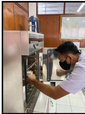
Memasukkan sampel sedimen ke dalam Oven
