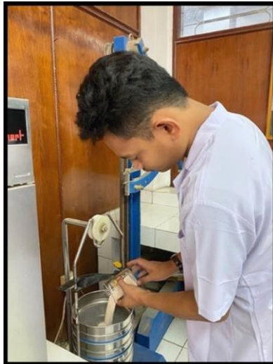
Mengayak sampel sedimen menggunakan shaker
