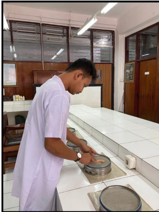
Mengidentifikasi sampel sedimen menggunakan sieve net
