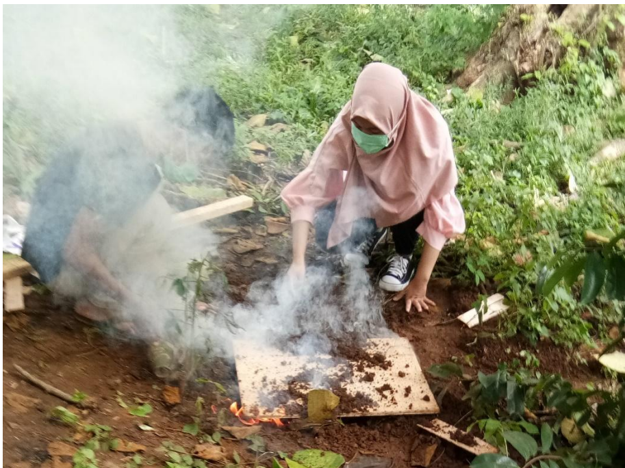
Lampiran 14. Proses Karbonisasi Arang Kayu Pinus di Lubang Tanah
