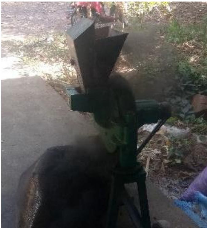
Lampiran 16. Proses Penggilingan Arang Menggunakan Hammer Mill
