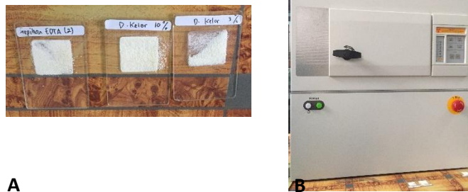
Gambar 3 A) Persiapan spesimen pada kaca preparat; B) Evaluasi pada alat X-Ray Powder Diffraction (XRD)
