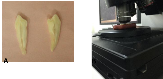
Gambar 3 A) Spesimen setelah dipotong; B) Pengamatan spesimen dengan alat Confocal Laser Scanning Microscopy (CLSM)
