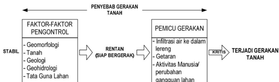
**Gambar 2. 3** Proses terjadinya gerakan tanah/batuan dan komponen-komponen penyebabnya (Mubekti & Alhasanah, 2008).
