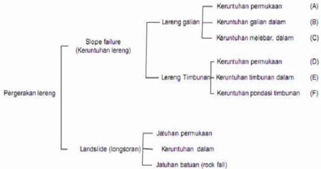
**Gambar 2. 4** Pergerakan lereng ditinjau dari jenis pada lereng buatan (BPSDM, 2017).
