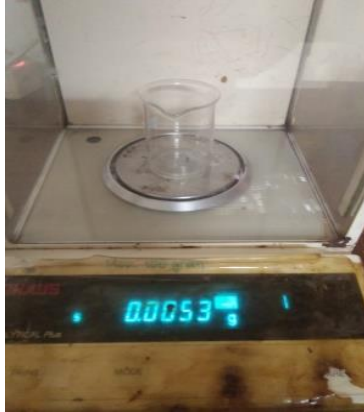
Pembuatan larutan p-t -butilkaliks[6]arena dengan menimbang 0,0053 gram
