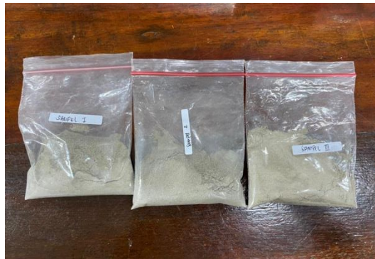
Sedimen setelah dikeringkan di oven dan digerus
