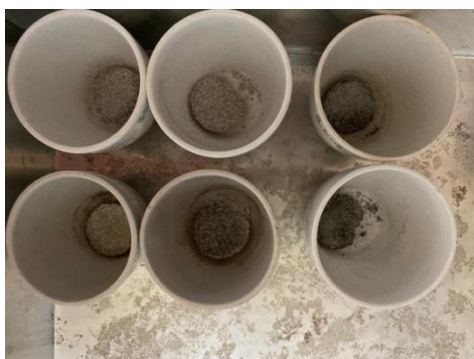
Rumput laut setelah dikeringkan di tanur
