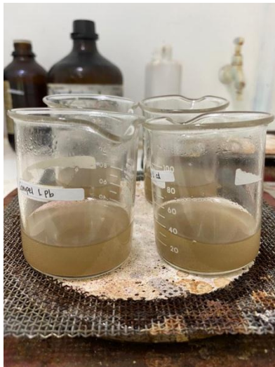
Proses destruksi sampel
