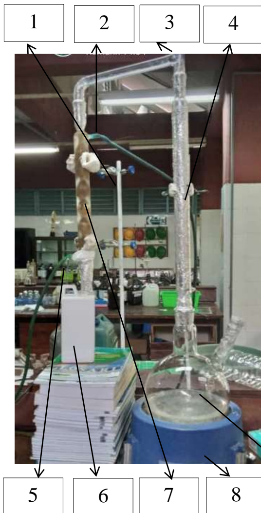
Gambar 23. Rangkaian Destilasi Fraksinasi
