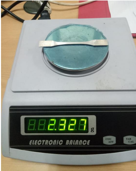
Gambar B.7 berat spesimen sebelum terkorosi
