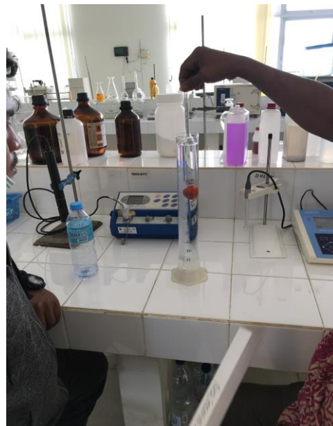
Gambar 4. Pengujian Salinitas Awal Air Laut
