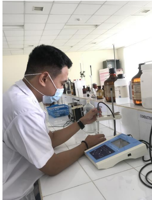
Gambar 9. Pengukuran TDS dan Suhu
