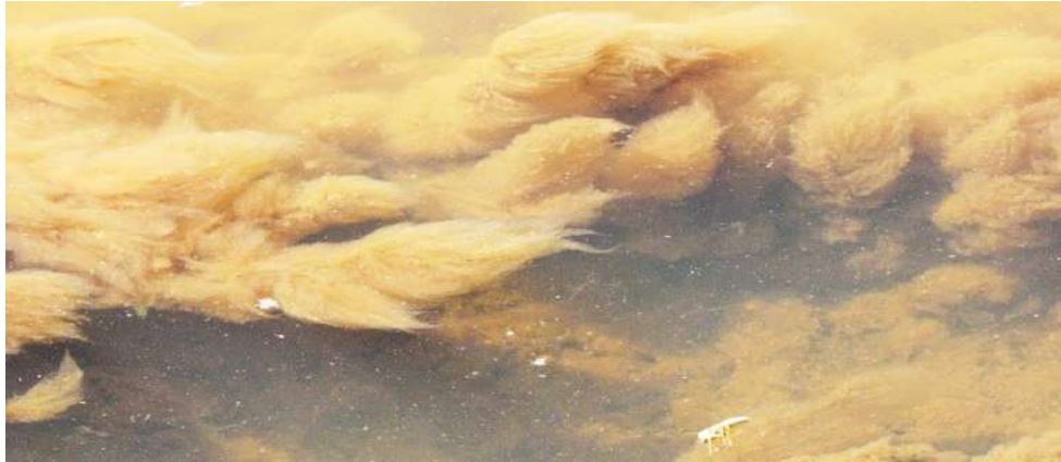
Gambar 12. Bulking yang di sebabkan oleh DO rendah ( Sphaerotillus Natans )
