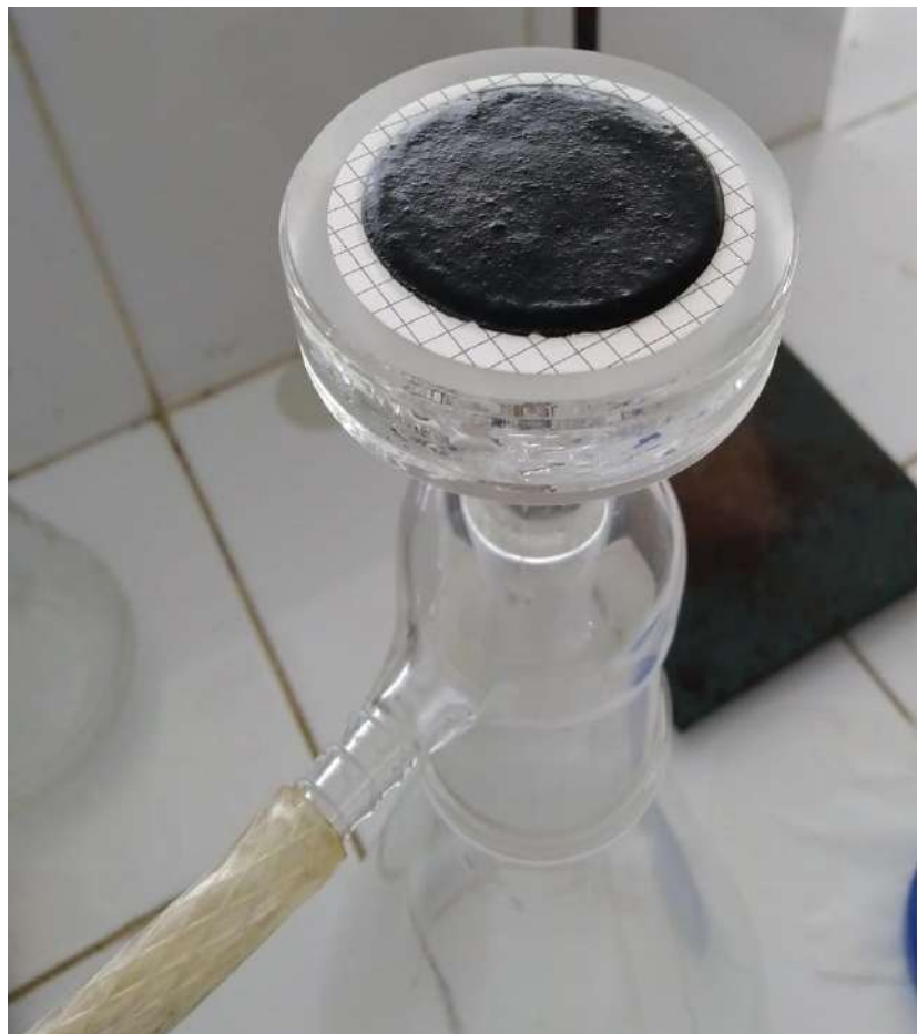
Gambar 40. Proses penyaringan untuk MLSS
