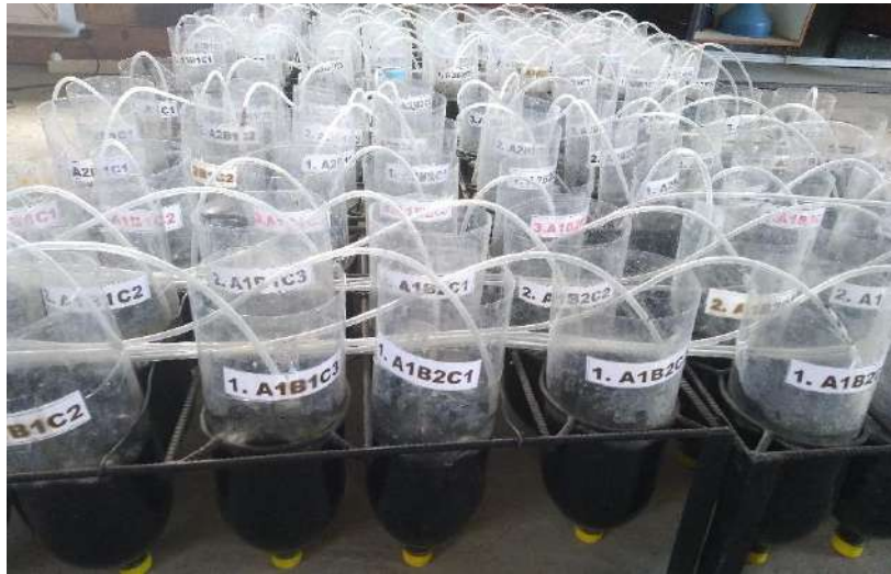
Gambar 37. Proses aerasi pada bioreaktor
