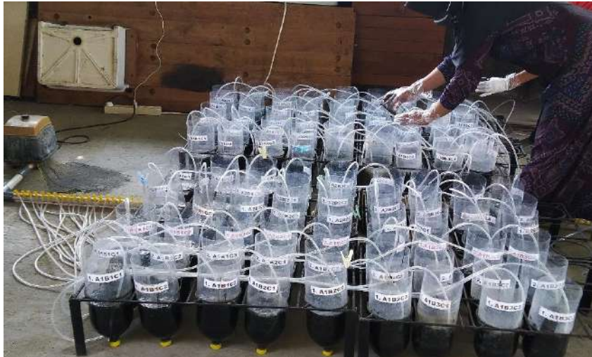
Gambar 39. Proses penambahan RAS pada biofilter
