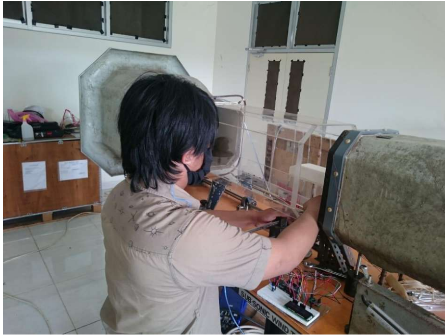
Pemasangan model kendaraan pada load cell
