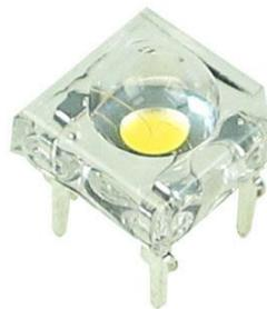
**Gambar 2.10. Super Flux LED**
