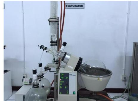
**Gambar 10. Proses penguapan pelarut menggunakan alat *Rotary evaporator***
