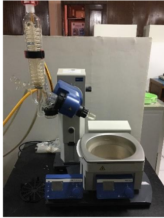
Lampiran 18. Dokumentasi pada saat Proses Ekstraksi menggunakan Alat Evaporator di Lab. Teknologi Hasil Perikanan Universitas Hasanuddin
