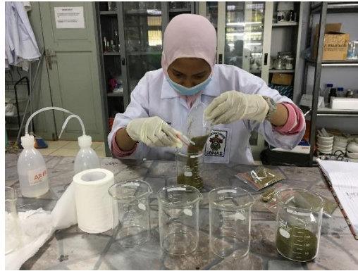
Lampiran 17. Dokumentasi pada saat Proses Maserasi Daun Trembesi menggunakan Pelarut Etanol 96% di Lab. Bioteknologi dan Pemuliaan Pohon
