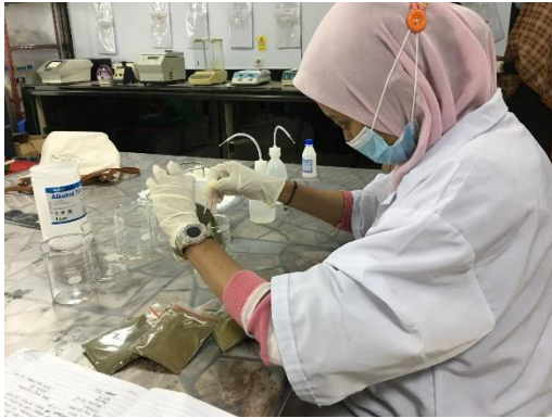
Lampiran 17. Dokumentasi pada saat Proses Maserasi Daun Trembesi menggunakan Pelarut Etanol 96% di Lab. Bioteknologi dan Pemuliaan Pohon
