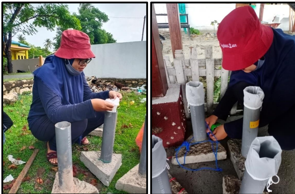
Gambar 13. Memasukkan kain saringan dan pengikatan sedimentrap
