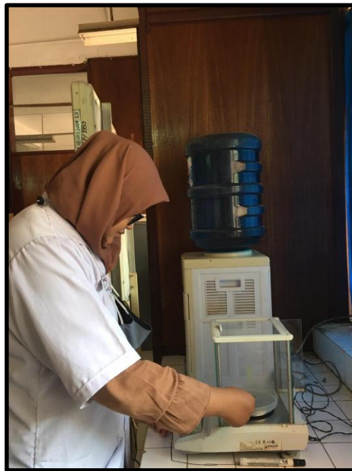
Gambar 22. Penimbangan sampel yang telah di oven
