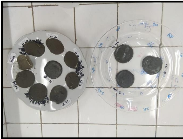
Gambar 21. Hasil penyaringan dan dimasukkan ke dalam oven
