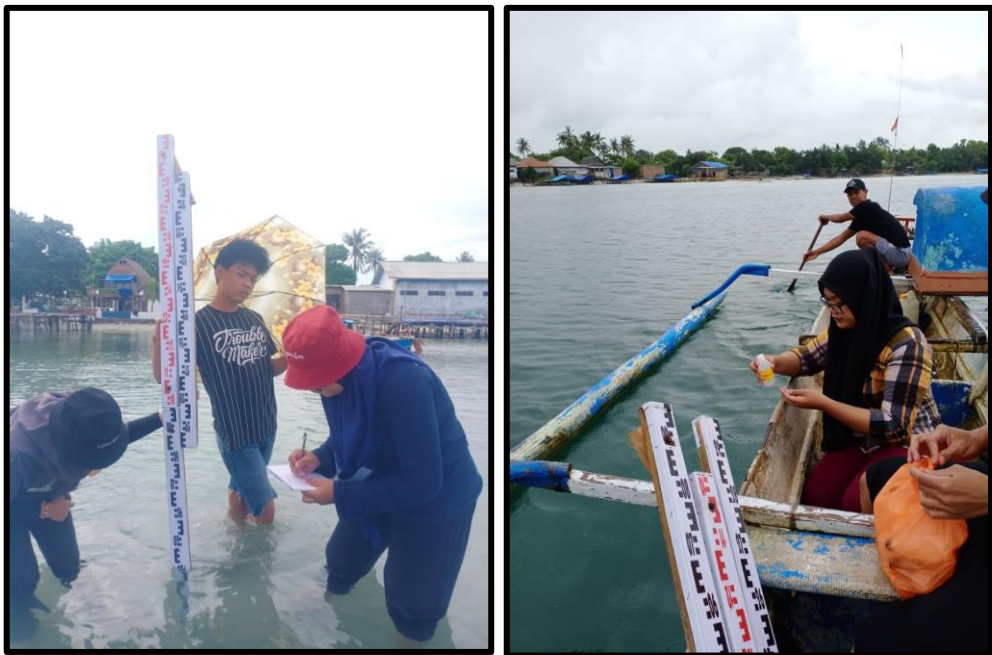
Gambar 15. Pengukuran tinggi gelombang dan pengambilan air sampel
