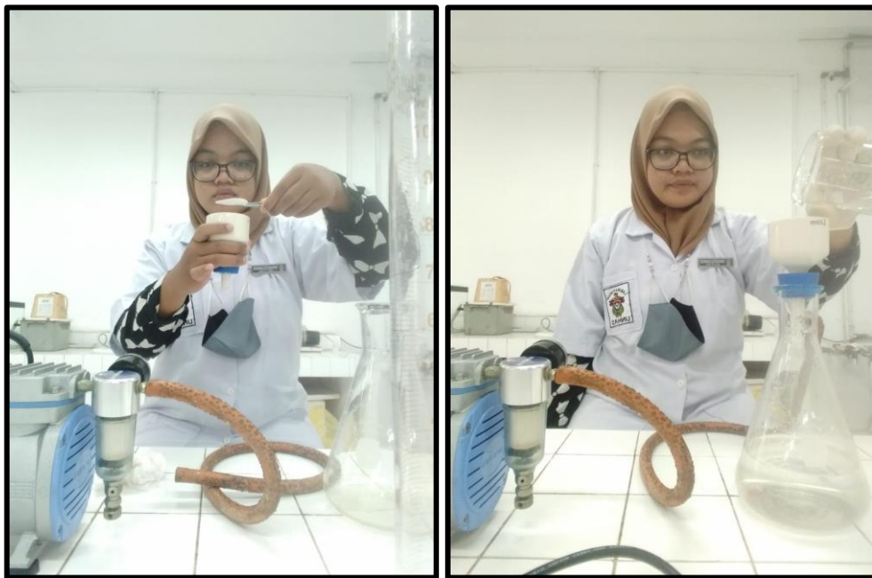
Gambar 20. Penyaringan sampel menggunakan Vacuum pump
